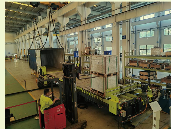
推板将货物推到链板前侧
