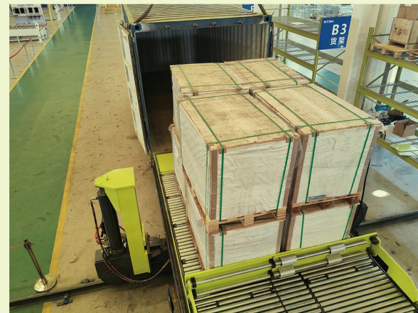
推板将货物推到链板前侧
